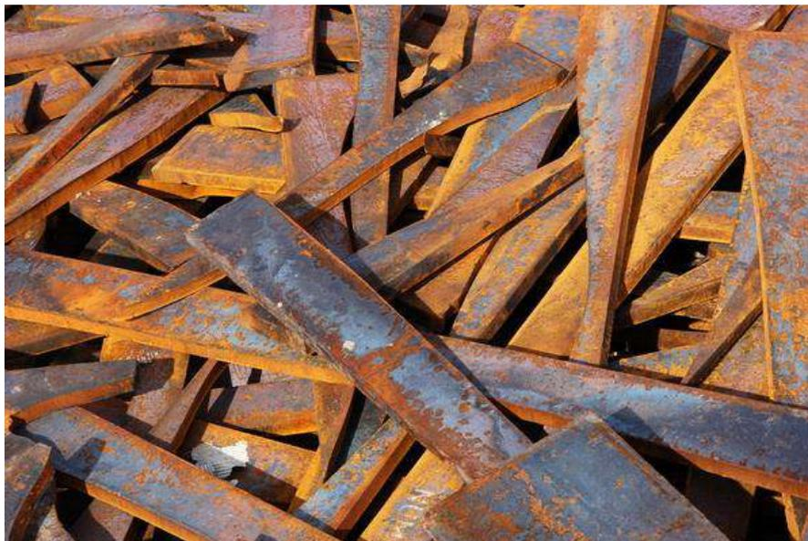
Кусковые лом и отходы, удобные для загрузки плавильных агрегатов.
