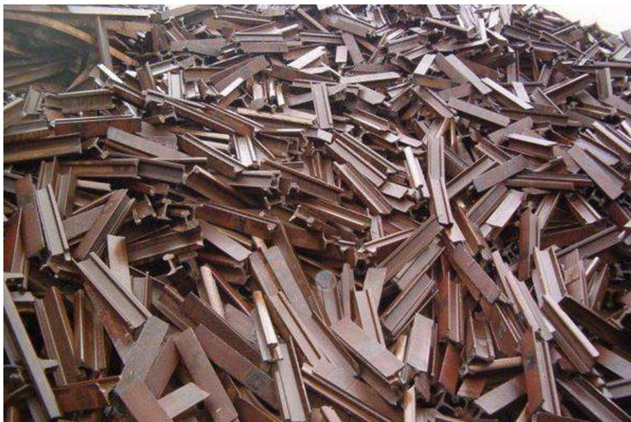
Кусковые лом и отходы, а также шихтовые слитки, удобные для загрузки плавильных агрегатов. Не допускаются проволока и изделия из проволоки.
