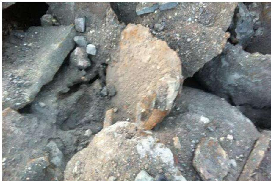
Проржавленные, подвергшиеся длительному температурному или кислотному воздействию, эмалированные и оцинкованные кусковые лом и отходы; чугунное крошье; дробь или гранулы; ржавая и спекшаяся стальная и чугунная стружка; зашла- кованный скрап.
