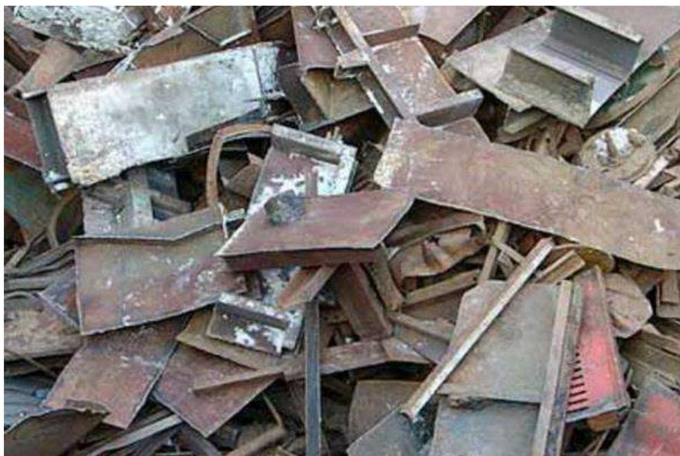
Кусковые лом и отходы и стальной скрап, удобные для загрузки плавильных агрегатов.
