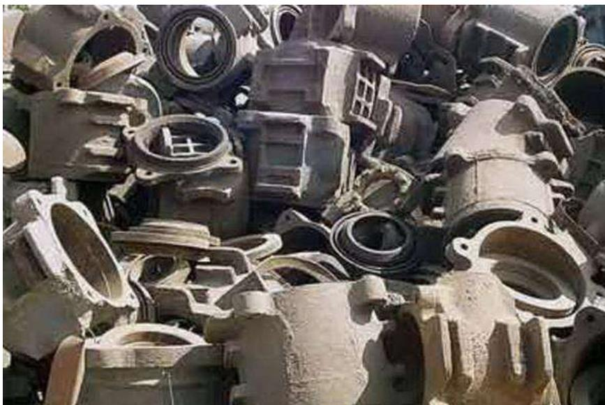
Куски чугуновых отливок с повышенным и высоким содержанием фосфора (печных, посудных, художественных). Куски ковкого чугуна, чугунные трубы.
