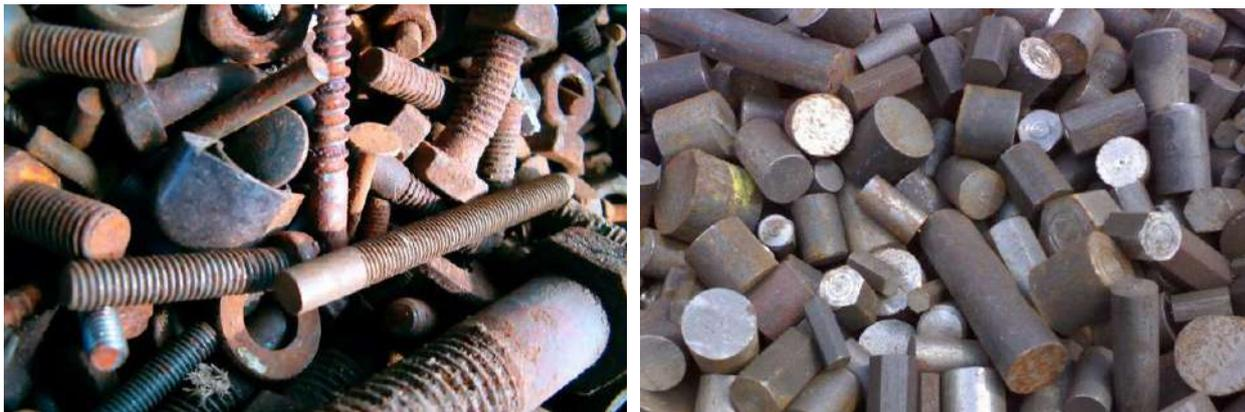
Мелкие кусковые отходы метизного и других производств, лом изделий метизного производства (костыли, болты, гайки и др.), удобные для загрузки плавильных агрегатов.
